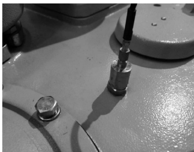
图4 YD-37型传感器现场装设图
